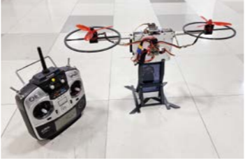
卒業生が設計・製作したバイコプタ
