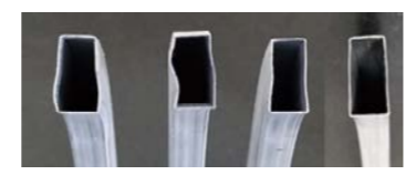
極薄肉方形管の回転引曲げによる断面変形
