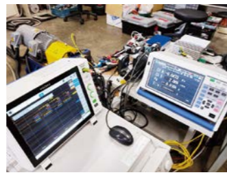
モータ試験時の電力等測定装置
