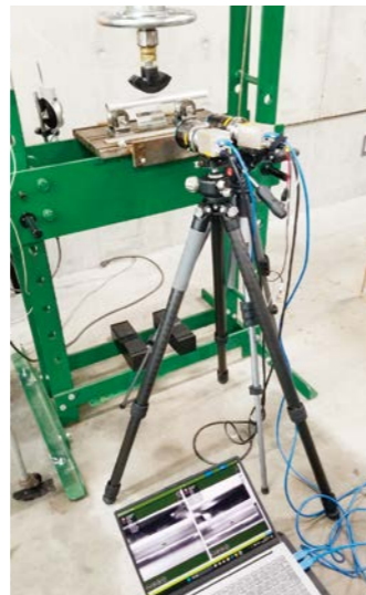
DIC(デジタル画像相関法)における 管材の曲げの応力一ひずみ
