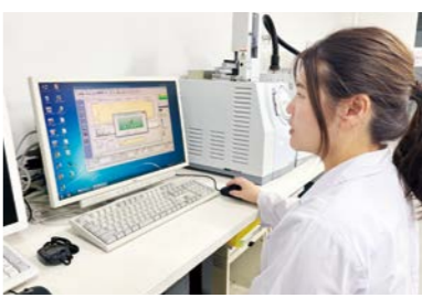
ガスクロマトグラフを用いたにおい物質濃度の測定
