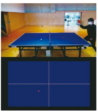
加速度センサによる卓球ボールのバウンド位置計測例：上は入力画像、画像処理によりバウンド位置がリアルタイムに計測される。
