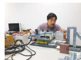
微破壊(小径ドリル型削孔)試験
