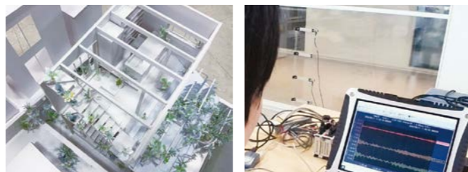
路上園芸の建築的利用 建物模型の振動計測
