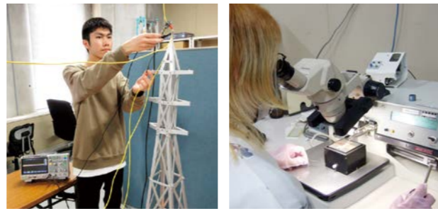
鉄塔サージの電圧測定 電子デバイスの金属線による実装
