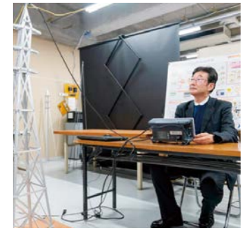
模擬鉄塔雷撃電流測定
