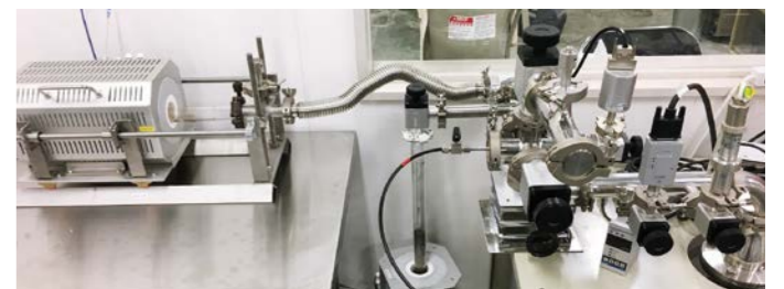
水素ガスチャージシステム
