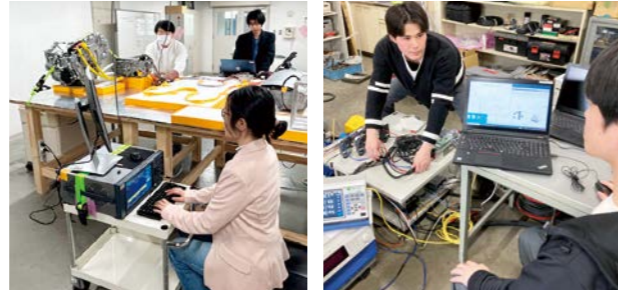
PHEV(Plug-in Hybrid Electric Vehicle)の電動駆動系システムの電磁ノイズ解析 ドローン用モータの特性評価試験
