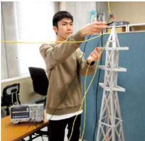
鉄塔サージの電圧測定
