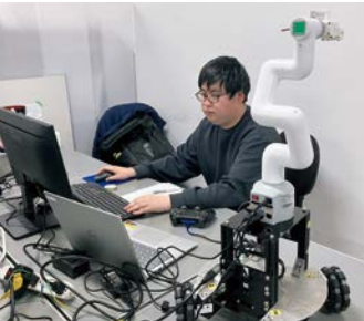
移動台車に搭載した ロボットマニピュレータによる品出し作業
