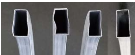
極薄肉方形管の回転引曲げによる断面変形
