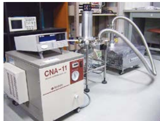
極低温デバイス評価システム
