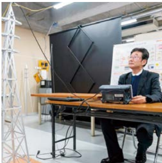
模擬鉄塔雷撃電流測定
