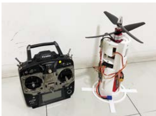
卒業生が設計・製作したデュアルコプタ
