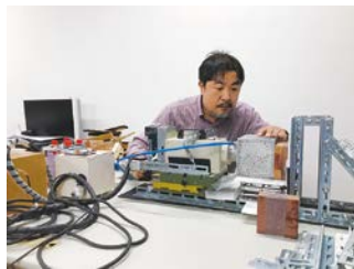
微破壊(小径ドリル型削孔)試験
