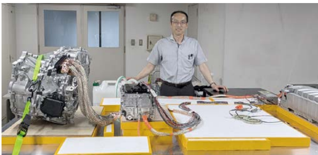
車両の伝導ノイズ伝搬の再現を目指し構築中のノイズ計測ベンチ
