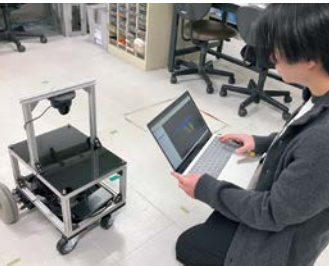
3D LiDARを用いたロボット周辺の測定と 自己位置推定
