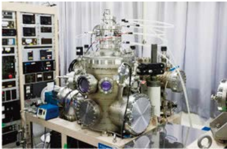
プラズマを用いた表面改質のための実験装置
