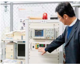
雷撃電流発生装置
