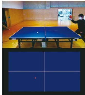
加速度センサによる卓球ボールのバウンド位置計測例：上は入力画像、画像処理によりバウンド位置がリアルタイムに計測される。
