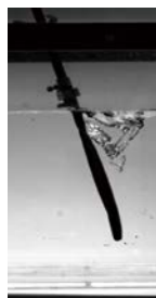
競技用カヌーパドルの縮小モデルによる実験の様子とシミュレーションによる渦構造
