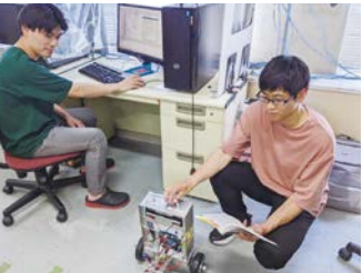
二輪型倒立ロボットの制御実験
