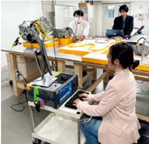
PHEV(Plug-in Hybrid Electric Vehicle)の電動駆動システムの電磁ノイズ解析
