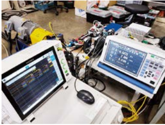
モータ試験時の電力等測定装置
