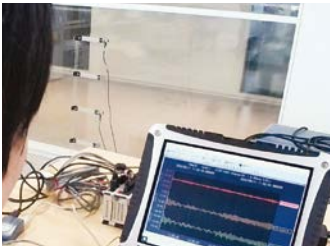
建物模型の振動計測
